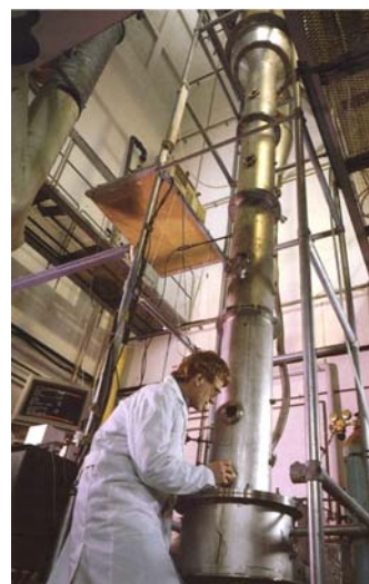
Fluidized bed reaktor for studier av bobledannelse og partikkel-hastigheter
